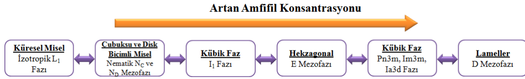
Şekil 2.11. Amfifil konsantrasyonuna bağlı olarak meydana gelen faz ve mezofazların şematik gösterimi
