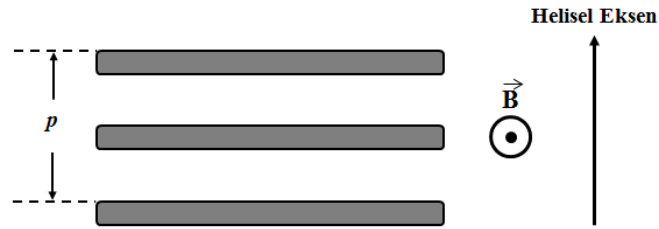
Şekil 4.38. Kiral yapının helisel eksen yönünü, dış manyetik alanın yönünü, \vec{B} ve kiral yapının adımını, p gösteren şematik gösterim.
