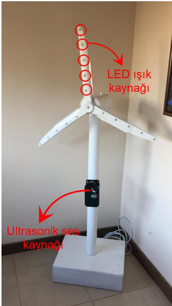
Şekil 3. Ses ve ışık modifikasyonları uygulanmış rüzgar türbini prototipi (Wind turbine prototype with sound and light modifications applied)
